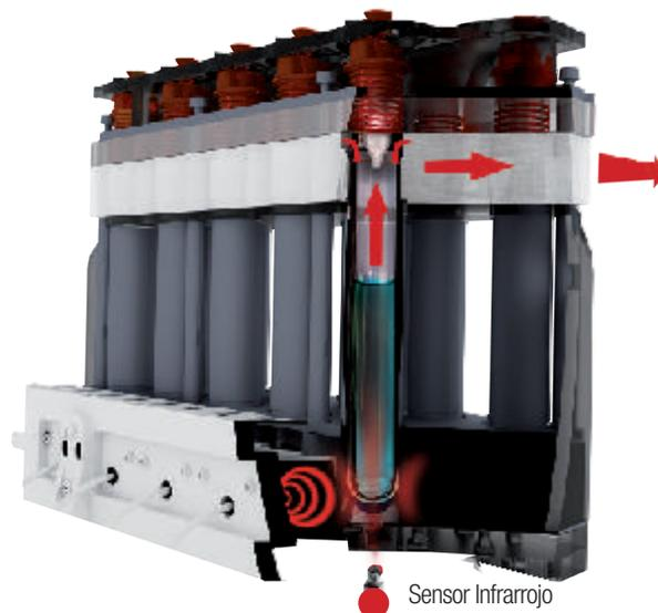
está constantemente variable, proporcionando así control de temperatura preciso para cada muestra independientemente. Una visualización dinámica de cada muestra aparece en la pantalla del equipo.
